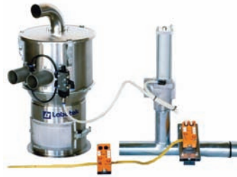
SVR mit IDV und Vakuumventil
